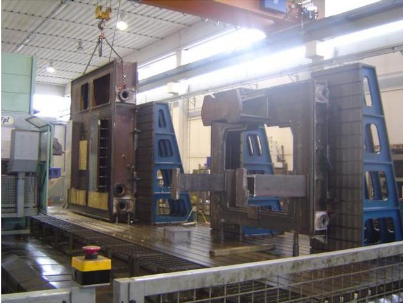
Steam turbine Baseplate 2,5 x 2,8m x 3T PEMEX – Minatitlan (MEXICO)
