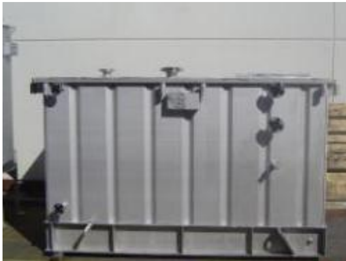
Rundown Vessel 2,1 x 3,1 x 3 m x 3T AISI SS 304
