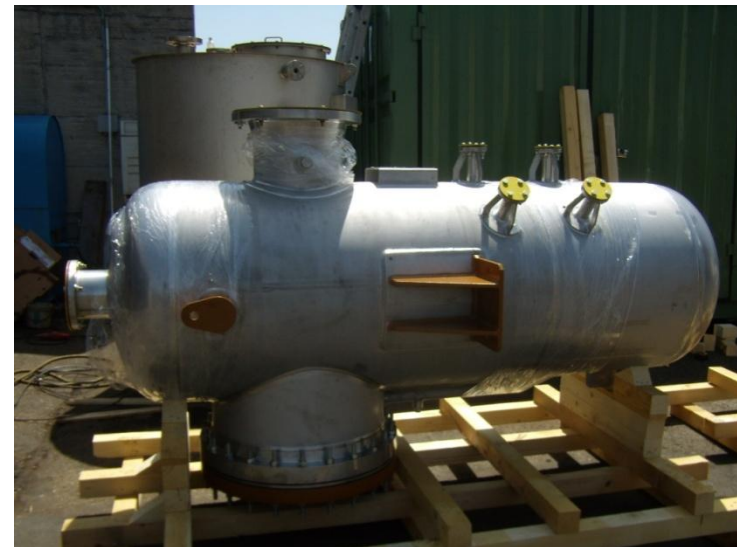
Nr. 4 Gas Separators AISI 321 SS Ø 0,75 x 2,5m x 12 mm GE Oil & GAS Avanzia for PMI – (Mexico)
