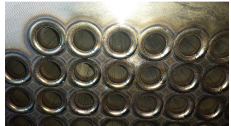
Nr. 1 Duplex oil cooler Material: Duplex SS ICA FLUOR PEMEX (Mexico)
